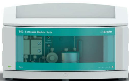
Внешний модуль 942 Extension Module Vario HPG сочетает в едином корпусе хроматографический насос высокого давления iPump с дегазатором элюента, клапаном дегазации, встроенным фильтром и демпфером пульсаций. При использовании насоса 942 Extension Module Vario HPG, изократическая система Professional IC Vario может быть расширена до системы с четвертичным градиентом.
